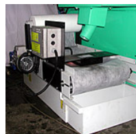
Esmeriladora orbital para tubos redondos y ovals Rotación contemporánea del disco A y de las bandas abrasivas B
